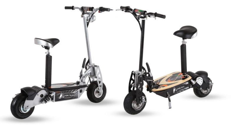
Model: 4-ALL EXTREME POWER: 1800W BATERRY:48V 12AH 4.4KG HEAVY SLA WEIGHT: 50KG MAX SPEED : 50KM/H RANGE: 40 KM
